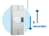
Positionnez le disjoncteur sur 0, attendez 5 secondes, puis remettez le disjoncteur en position 1. Cette manœuvre équivaut à un appui sur le bouton (+) du compteur, elle est interprétée par ce dernier comme une consigne de fermeture de l'organe de coupure.
